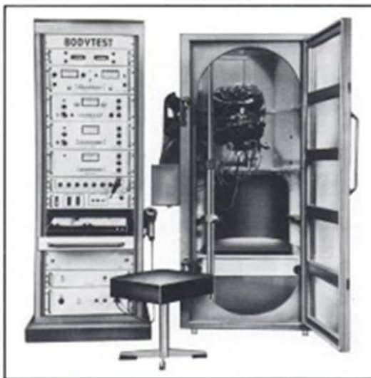
Pletismografo corporal de corpo inteiro, de pressão e volume constantes. Medições para espirometria clássica, Pneumotacografia, Pletismografia e também Débito Cardíaco método N 2 O, Closing volume etc.
